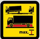
> Activer la suspension pneumatique: garde au sol maximale
