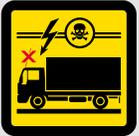
> Interdiction de montage de l'antenne sous la caténaire
